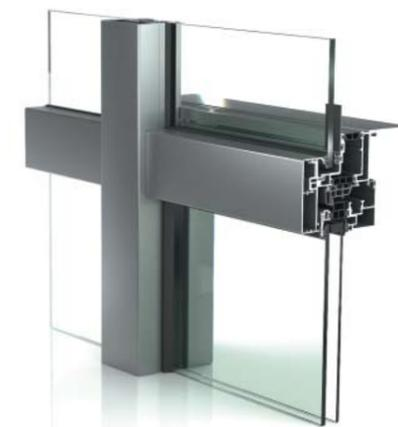
Als Lochfenster oder Fensterbandverglasung wird in der Außenansicht eine Fensterstruktur oder alternativ der Stil einer Pfosten-Riegel-Fassade mit aufklipsbaren Deckleisten erzielt. Die Verglasung ist geschoss- und abschnittsübergreifend als Kalt-Warm-Fassade möglich. Damit bietet diese Technik auch eine ideale Lösung für die Sanierung von Gebäuden mit Fensterbändern auf Brüstungen.
